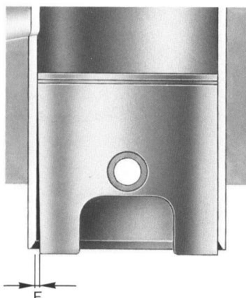
Kontrollera kolvens slitage på skörtet genom att placera den i cylinderns nedre del som fig. visar.
