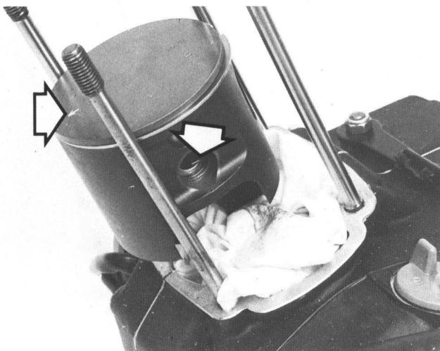
Innan kolven monteras på vevstaken, kontrollera nållagret avseende skador och slitage.
